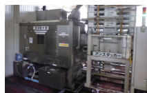
製品運搬パレット洗浄装置
